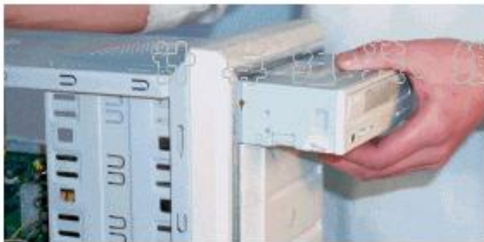
图1-16 将光驱装入机箱
