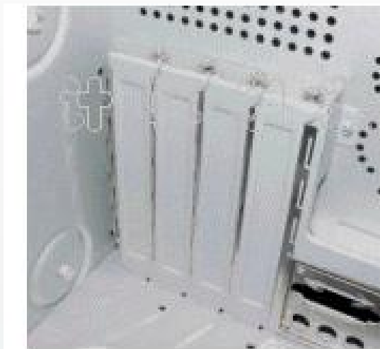
图1-18 AGP插槽上的扩充挡板及螺丝
