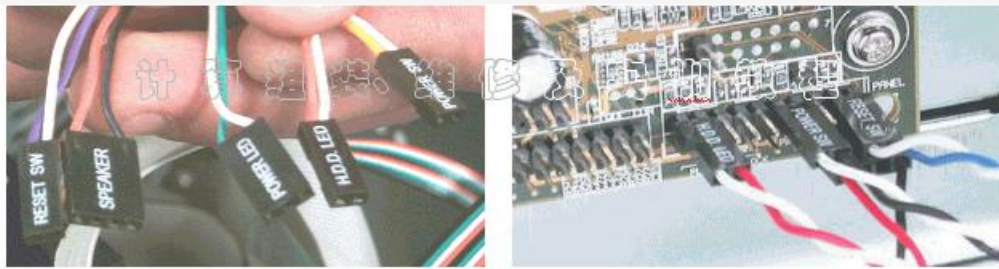
图1-10 机箱内部的各种连线 图1-11 连接机箱内部连线
